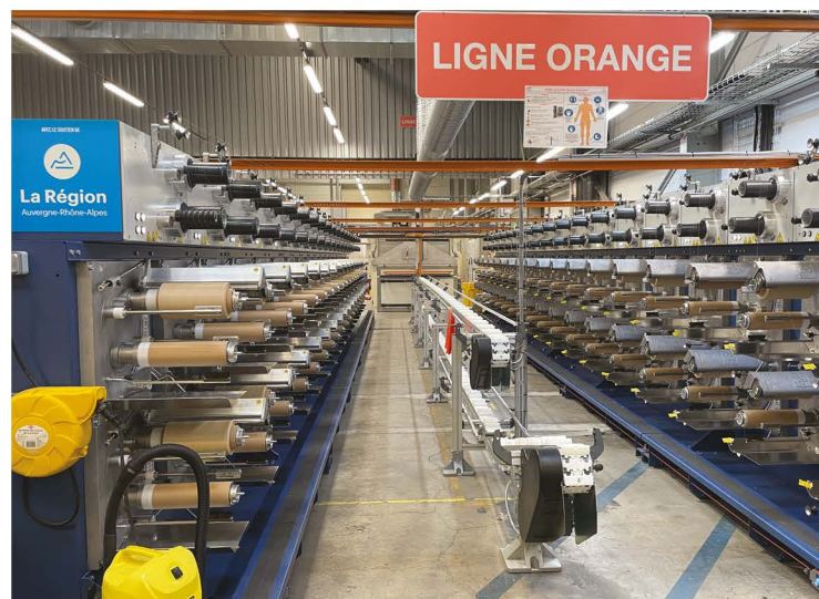
La ligne d'enduction Orange, installée début 2022 avec le soutien de la région Auvergne-Rhône-Alpes, est plus automatisée que les quatre premières.
