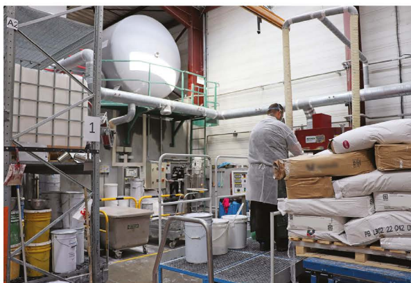
La recette de plastisol est composée de 10 à 15 produits : des pigments pesés au gramme près, des solvants et des plastifiants. Aux deux postes, une cuve est placée sous le mélangeur. Chaque cycle est lancé à une température précise pendant une durée donnée.
